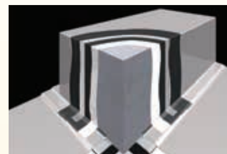
ロンレタン防水とシートの取り付け例(架台部)
