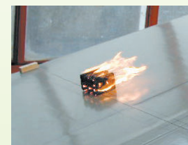
防火 (飛び火) 試験
