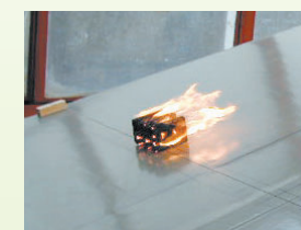
防火 (飛び火) 試験
