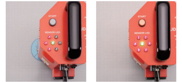
本体とディスクがずれている時
