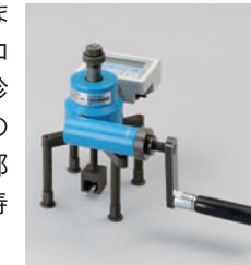
ビス引き抜き試験機
